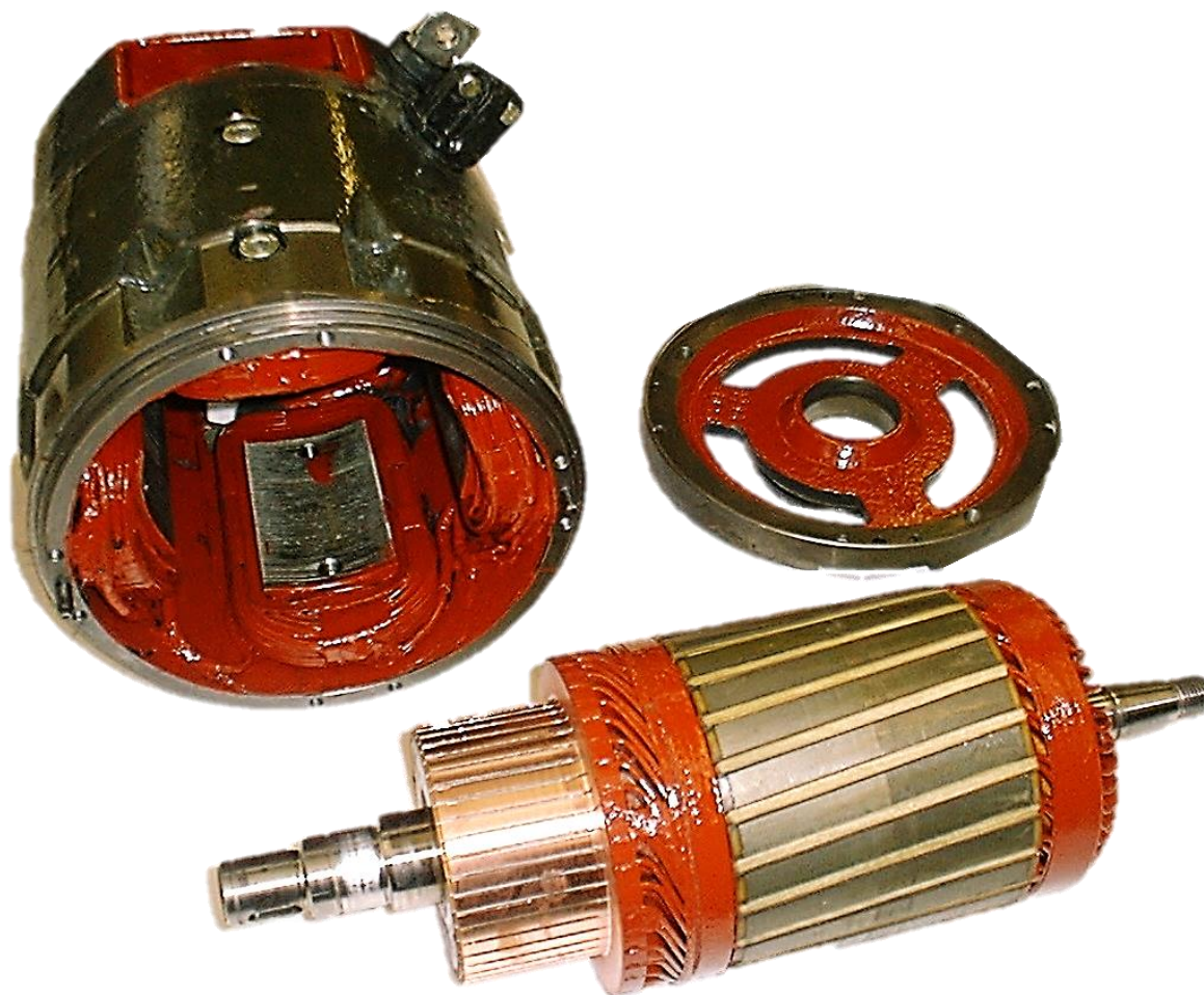
HÌNH H 4.1: Phần cảm (stator) và phần ứng (rotor) của máy điện một chiều.
