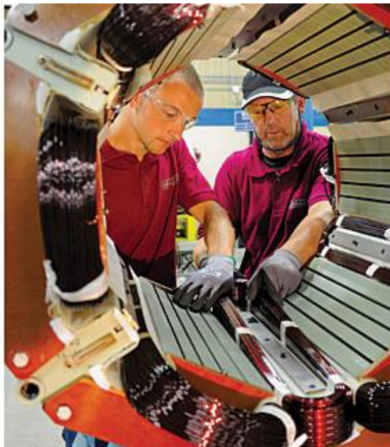
Stator có cực từ chính và phụ
