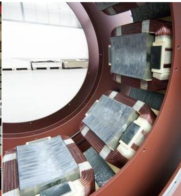
Stator chỉ có cực từ chính
